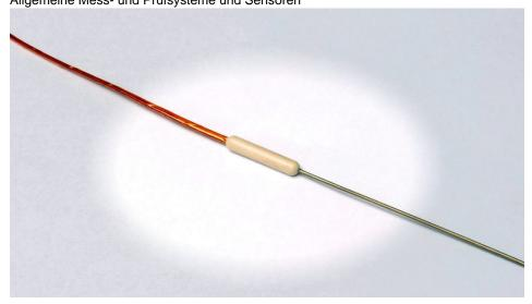
Anschlusshülsen übernehmen an Thermoelementen und Widerstandsthermometern die Rolle eines Gehäuses (Bild: hotset).
