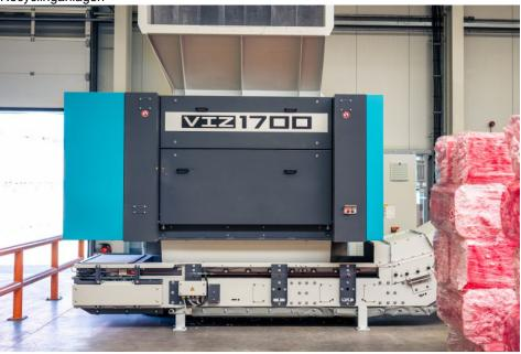
Der Zerkleinerer hat eine Durchsatzleistung von ca. 2000 kg/h und arbeitet mit geringen Betriebskosten (Bild: Vecoplan).
