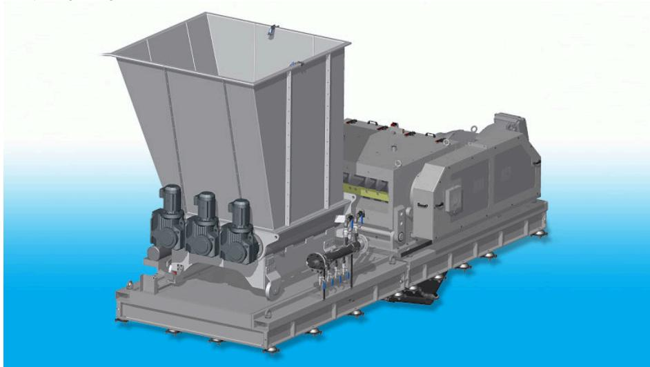
Die mit einer Zwangszuführung ausgestattete Hochleistungs-Nassschneidmühle arbeitet besonders energiesparend (Bild: Hellweg).
