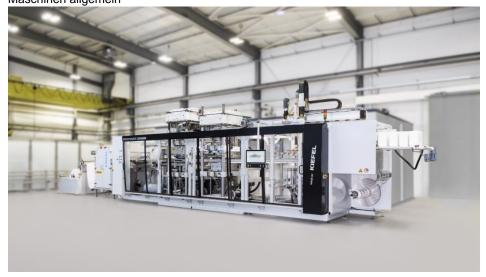
Die neue Thermoformanlage bietet einen höheren Ausstoß an Polymerverpackungen und erreicht bis zu 45 Takte pro Minute (Bild: Kiefel).
