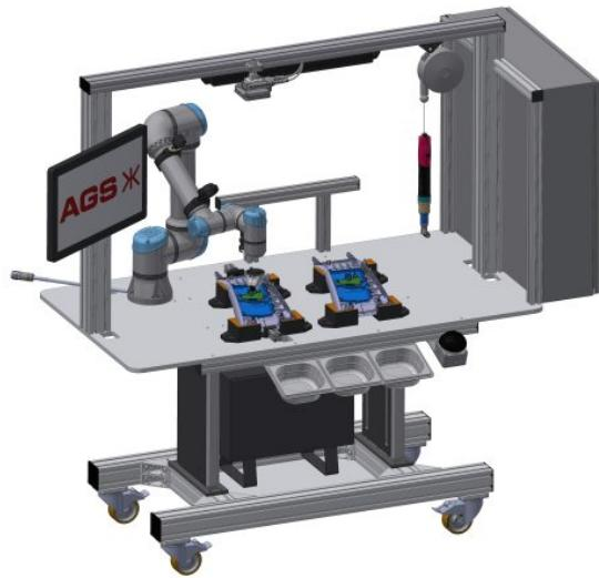
Der höhenverstellbare Arbeitsplatz mit Cobot ist mobil und somit sehr flexibel einsetzbar (Bild: AGS).
