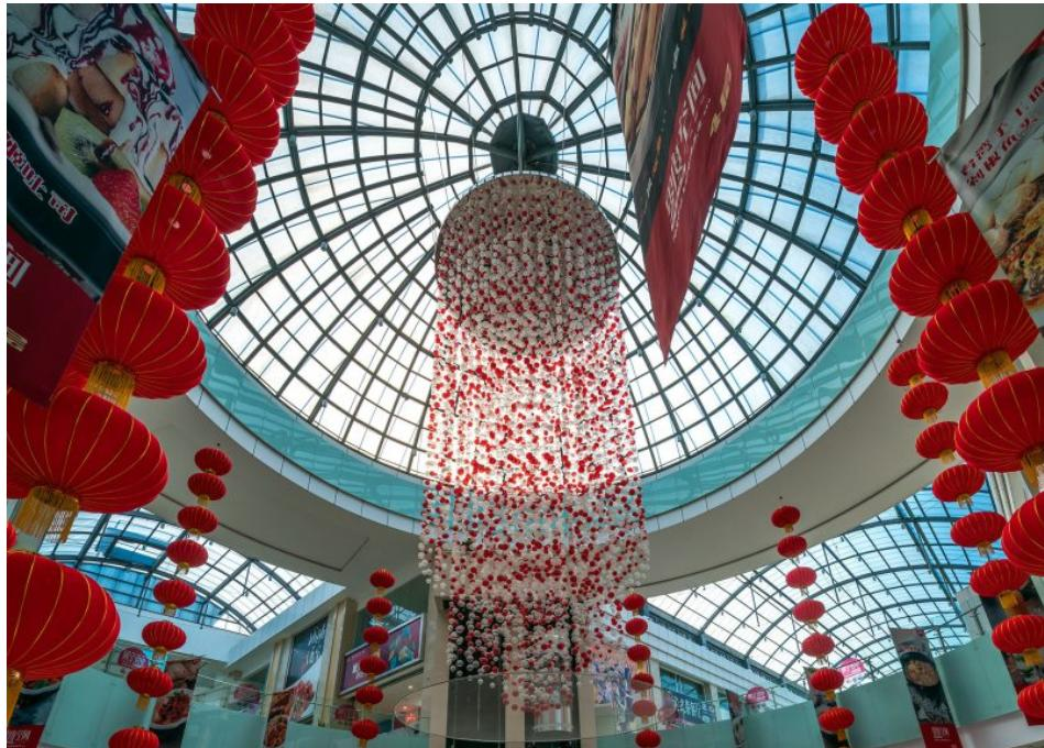
Transparente Dachverglasungen sind eine der bevorzugten Anwendungen von Polycarbonatplatten, für die Tosaf eigenschaftsverbessernde Additive und Compounds herstellt (Bild: Palram Ind. Ltd.).
