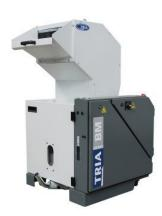
Das Einstiegsmodell für die Hohlkörperzerkleinerung deckt mit einer Leistung von 80 Kilogramm pro Stunde bereits viele Anwendungen ab (Bild: Tria).
