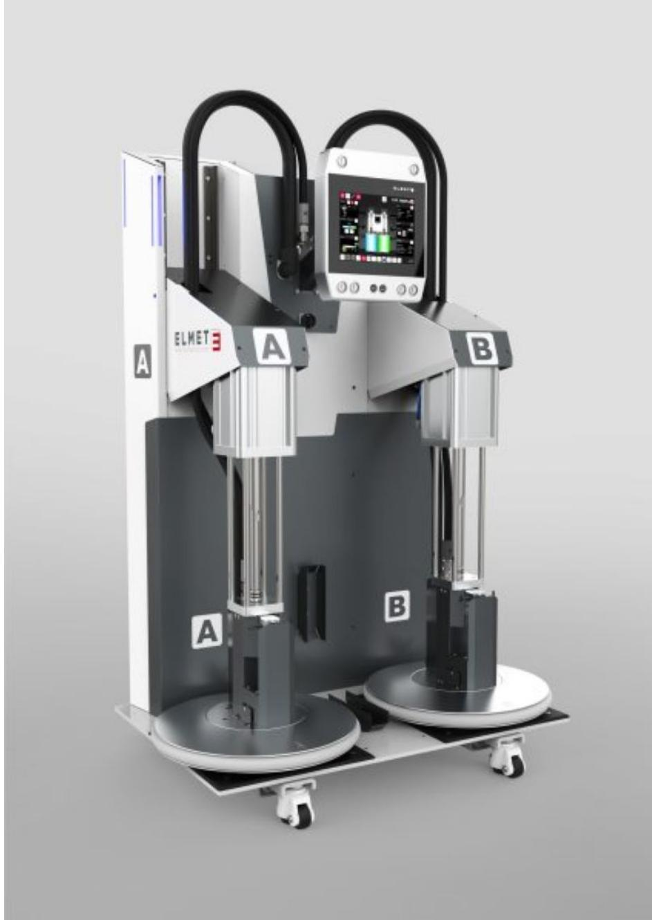
Das Dosiersystem »Smartmix Top 7000P« ist FDA-konform ausgelegt und somit besonders für die hochreinen optischen LSR-Typen geeignet (Bild: Elmet).
