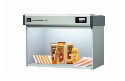
Alternative LED-basierte Kabinen und Stationen zur Abmusterung von Kunststofferzeugnissen sind bereits erhältlich (Bild: Just Normlicht).
