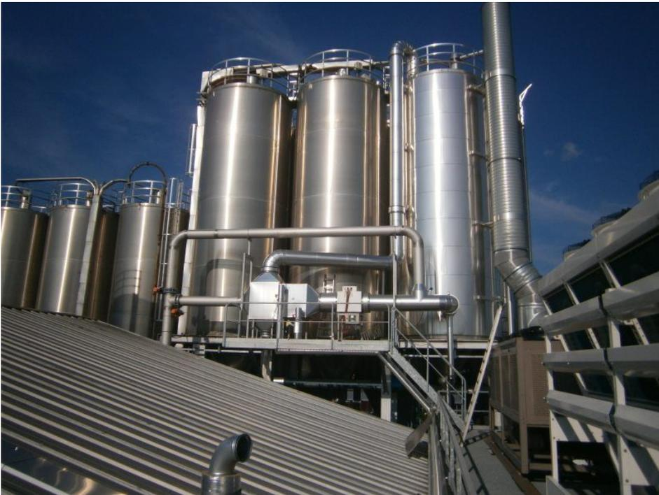
Die Desodorierungsanlagen (rechtes Silo) können auch in bestehende Materialzuführanlagen integriert werden (Bild: Zeppelin Systems).
