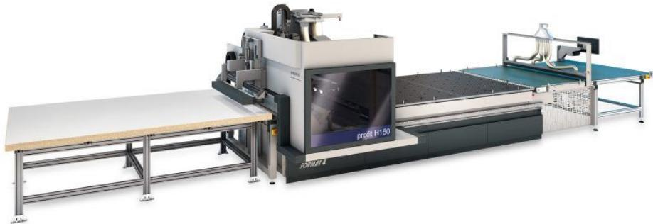
Die neue 5-Achs-Nestingmaschine ermöglicht effiziente Kunststoffbearbeitung für kleine und mittlere Werkstätten sowie für die Industrie (Bild: Felder).
