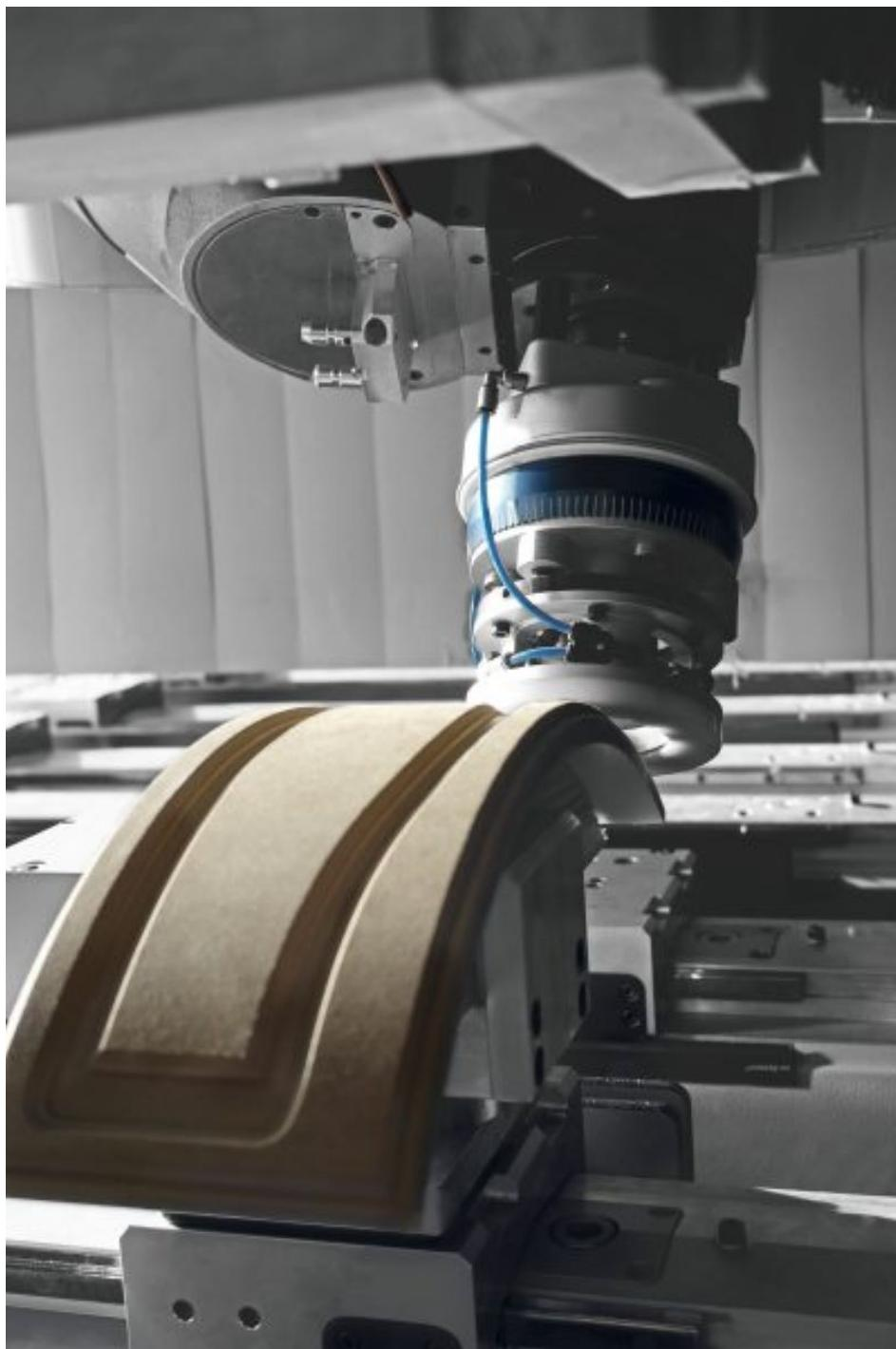
Zusatzzaggregate erweitern die Bearbeitungsmöglichkeiten der CNC-Maschine (Bild: Felder).
