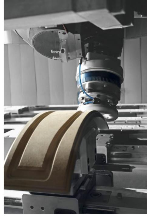
Zusatzaggregate erweitern die Bearbeitungsmöglichkeiten der CNC-Maschine (Bild: Felder).
