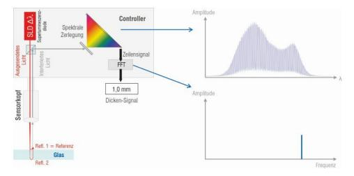
Prinzipieller Aufbau eines Weißlichtinterferometers. Die Analyse des Spektrums des Interferenzsignals ermöglicht eine sehr hohe Präzision (Bild: Micro-Epsilon).
