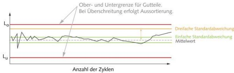
Abb. 1: Mithilfe der Werkzeuginnendruckmessung lassen sich in der Produktion Gut- und Schlechteile automatisch unterscheiden und sortieren. Die Daten geben auch Aufschluss, wie robust und fähig der Prozess ist (Bild: Kistler).
