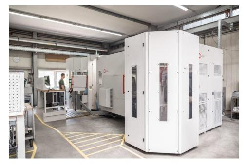
Das Bearbeitungszentrum mit Automation und Werkzeugmagazin für 130 Werkzeuge ist fast rund um die Uhr in Betrieb (Bild: Hermle).
