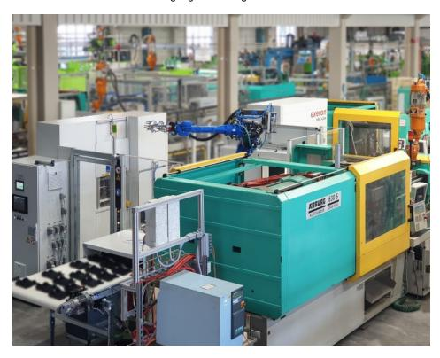
Klug kombiniert: Von der Spritzgießmaschine mit Schnellwechsel-Werkzeugeinsätzen werden die Bauteile per Roboter direkt an die CNC-Bearbeitung übergeben (Bild:
