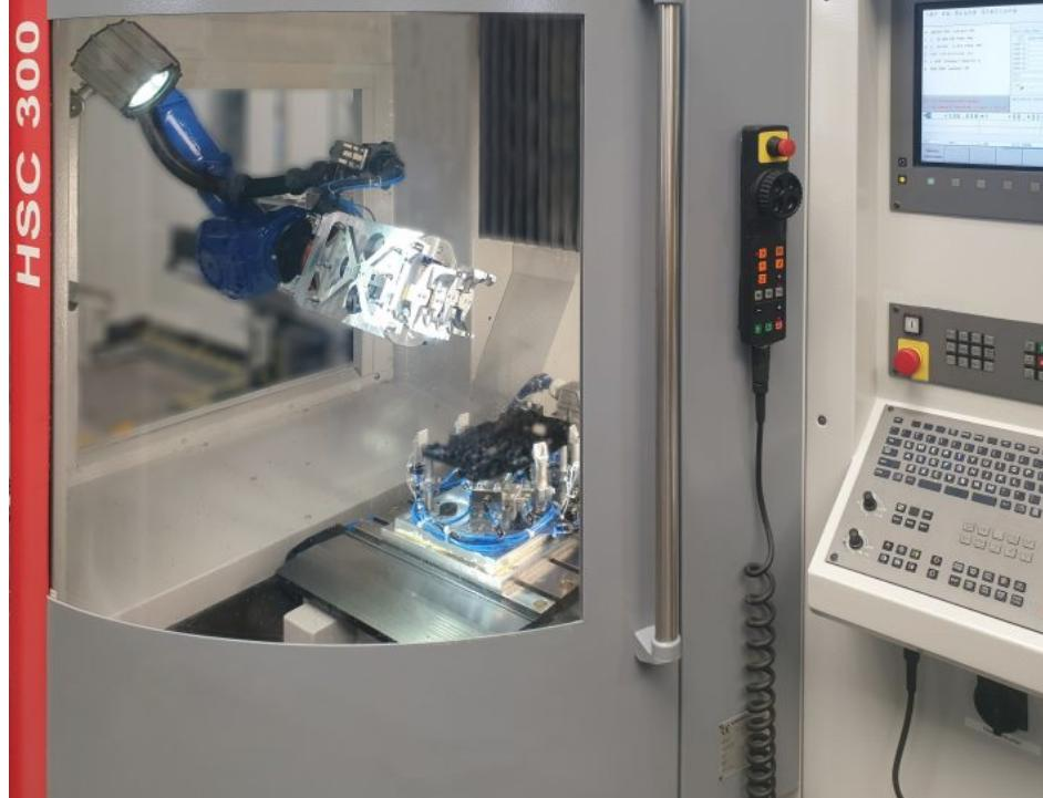
Durch Fräsbearbeitung können direkt in der Produktionszelle Varianten des komplexen Spritzgießteils erzeugt werden (Bild: Weiss).
