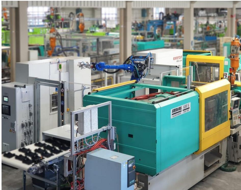
Klug kombiniert: Von der Spritzgießmaschine mit Schnellwechsel-Werkzeugeinsätzen werden die Bauteile per Roboter direkt an die CNC-Bearbeitung übergeben (Bild:
