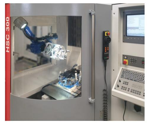
Durch Fräsbearbeitung können direkt in der Produktionszelle Varianten des komplexen Spritzgießteils erzeugt werden (Bild: Weiss).
