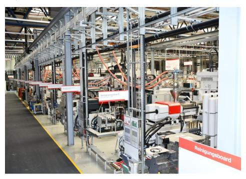
Hochwertige Produkte erfordern ein entsprechendes Umfeld. Bei fischer in Denzlingen produzieren 14 Spritzgießmaschinen die Kartuschen, die für Hochleistungs-Ein- und - Mehrkomponentenmörtel benötigt werden. Die Abwärme aus der Maschinenkühlung wird als kostenlose Heizwärme in verschiedenen Unternehmensbereichen genutzt (Bild: ONI).
