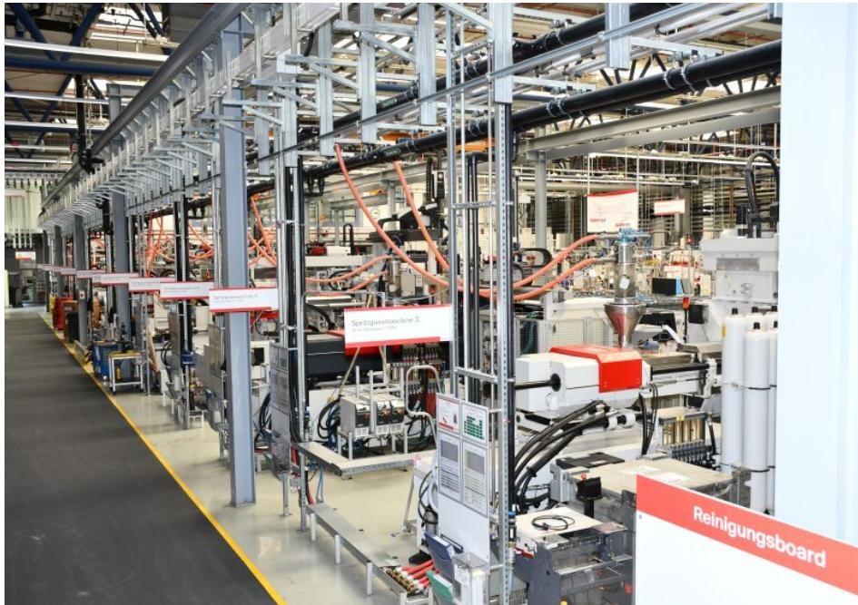
Hochwertige Produkte erfordern ein entsprechendes Umfeld. Bei fischer in Denzlingen produzieren 14 Spritzgießmaschinen die Kartuschen, die für Hochleistungs-Ein- und - Mehrkomponentenmörtel benötigt werden. Die Abwärme aus der Maschinenkühlung wird als kostenlose Heizwärme in verschiedenen Unternehmensbereichen genutzt (Bild: ONI).
