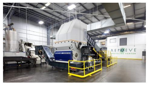
Drei Schredder bereiten bei Unifi Kunststoff- und Textilabfälle vor (Bild: Lindner).
