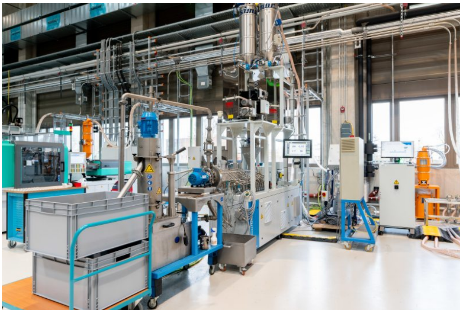
Extruder »KM ZE28 BluePower« von KraussMaffei im IKK (Bild: Nico Niemeyer).
