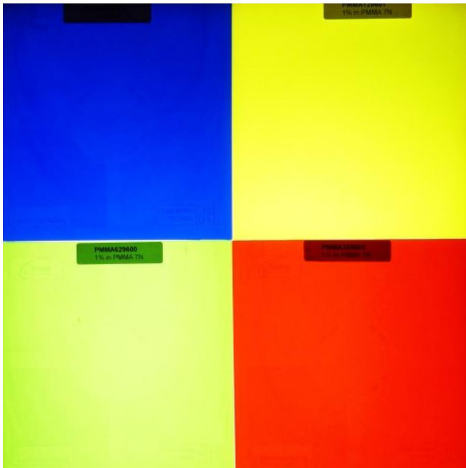
Lichtstreuende Masterbatche sorgen auch bei LED-Punktstrahlern für eine gleichmäßige Ausleuchtung (Bild: Tosaf).
