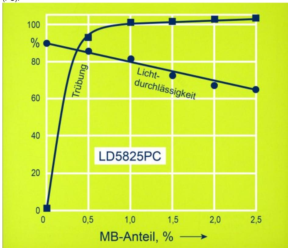
Schon geringe Masterbatch-Mengen bewirken eine effiziente Lichtstreuung in ursprünglich transparentem Polycarbonat (Bild: Tosaf).
