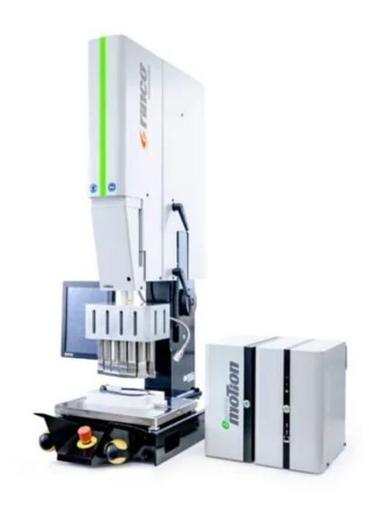
»Electrical Motion« eignet sich zum Schweissen, Schneiden und Stanzen von Thermoplasten, Non-wovens und Textilien (Bild: Rinco).
