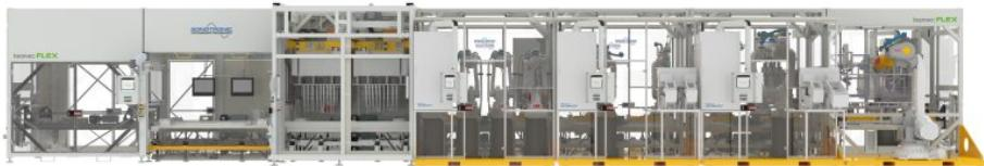
Die flexiblen Bearbeitungsanlagen mit Ultraschallmodulen erleichtern das Fügen und Umformen von Kunststoffen (Bild: Sonotronic).
