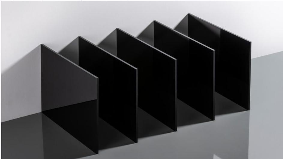
Die Acrylglasplatten enthalten ca. 90 % rezykliertes Material (Bild: Röhm).
