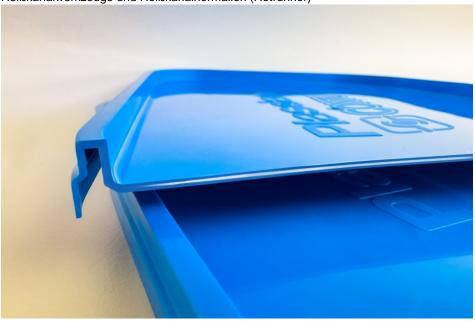
Nahaufnahme des Querschnitts eines Kunststoffdeckels in Sandwich-Technologie mit ca. 30 % weißem Mahlgutanteil (Bild: Contura MTC).
