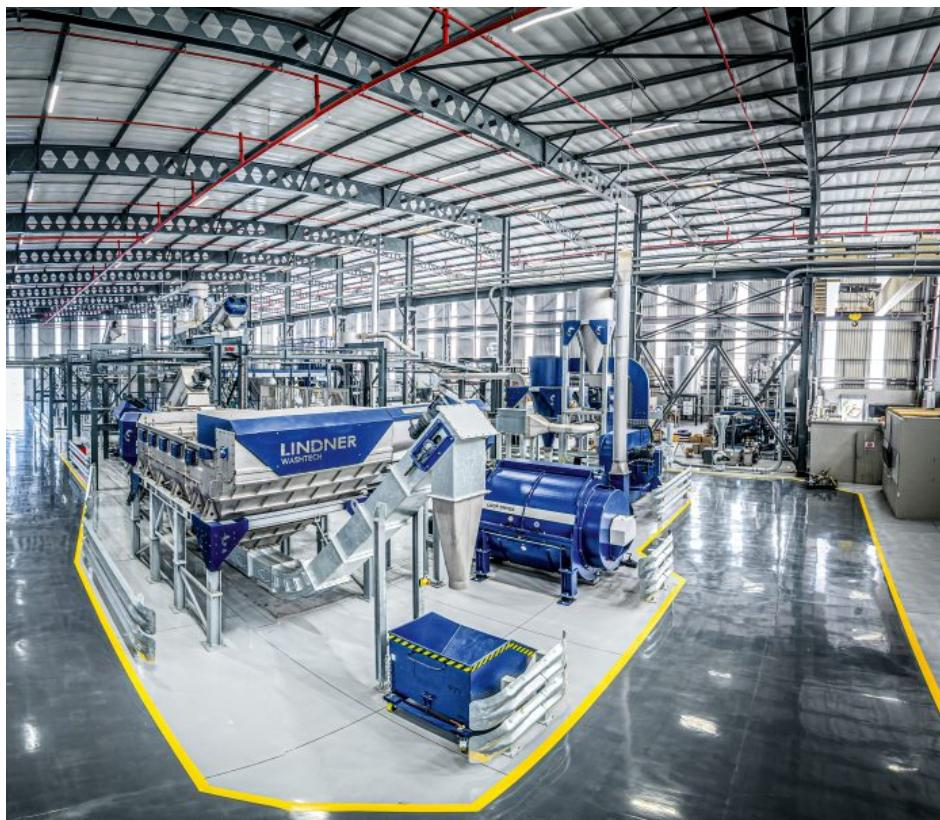
Beispiel für eine modulare Komplettwasch- und Sortieranlagen für das Recycling von thermoplastischen Kunststoffen (Bild: Lindner).
