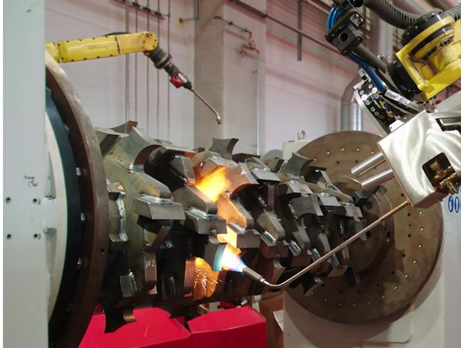
In der vollautomatischen Scheibenschweißanlage sind 2 Schweißroboter 24/7 im Einsatz (Bild: Lindner).
