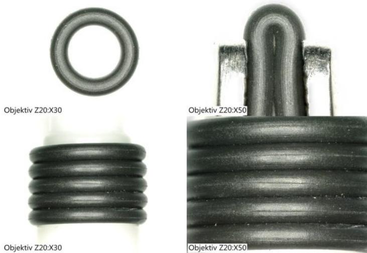
Auch eine Knick- und Dehnprüfung belegt, dass bei richtiger Lagerung die beschichteten Dichtungen besser werden (Bild: OVE).
