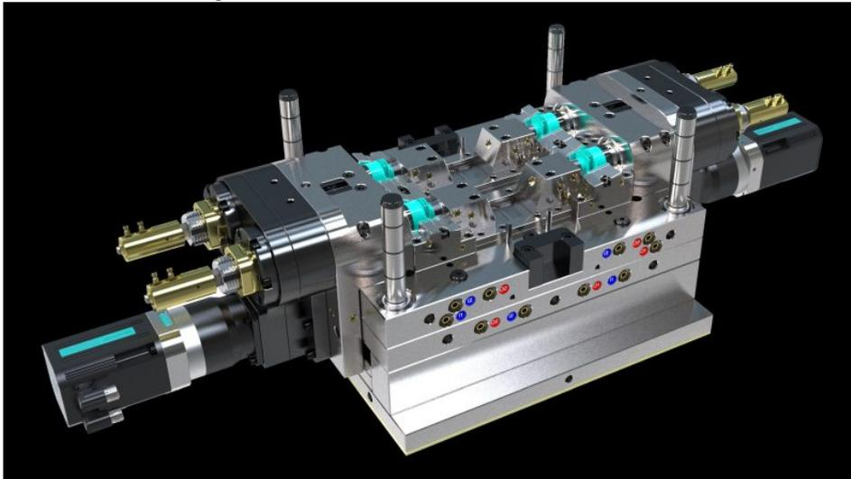
Das Unternehmen produziert servoelektrische Ausschraubsysteme und Linearaktuatoren für eine effiziente, saubere und sichere Spritzgießproduktion (Bild: Servomold).
