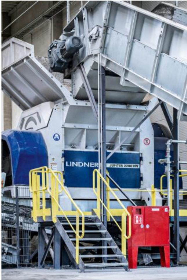
Mit auf Folienrecycling zugeschnittenem Schredder-Setup konnte der Feingutanteil um bis zu 44 % reduziert werden (Bild: Lindner).
