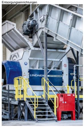
Mit auf Folienrecycling zugeschnittenem Schredder-Setup konnte der Feingutanteil um bis zu 44 % reduziert werden (Bild: Lindner).
