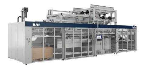
Der einstellbare Spannrahmen der Platten-Thermoformmaschine ermöglicht die Verwendung von an das Produkt angepassten Plattengrößen (Bild: Illig).
