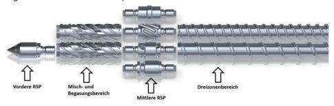
Die einzelnen Funktionsbereiche der modular aufgebauten Schnecken können beliebig kombiniert werden (Bild: KraussMaffei).
