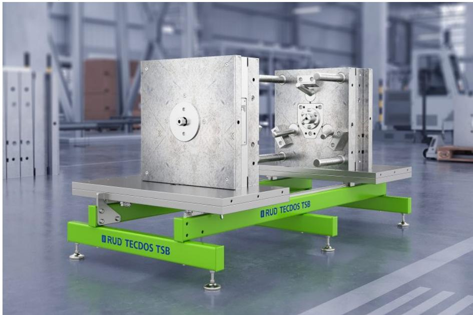
Mit dem neuen Werkzeugöffner lassen sich 2,5 t schwere Werkzeuge einfach, schnell und sicher von Hand öffnen und schließen (Bild: RUD).
