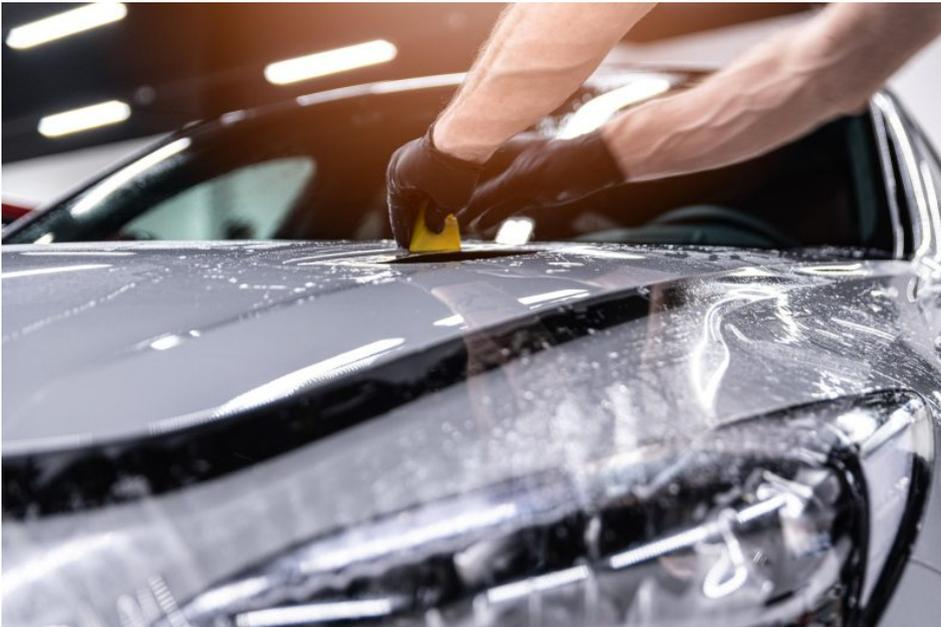
Die neuen Lackschutzfolien bieten hohe Witterungsbeständigkeit und Schlagfestigkeit (Bild: Covestro).
