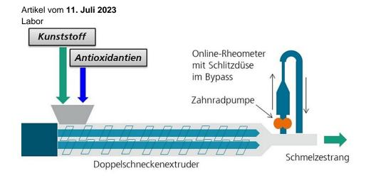
Schema des Versuchsaufbaus mit Doppelschneckenextruder und Online-Rheometer (Bild: Fraunhofer LBF).
