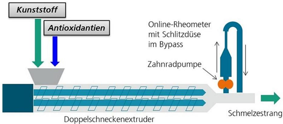
Schema des Versuchsaufbaus mit Doppelschneckenextruder und Online-Rheometer
