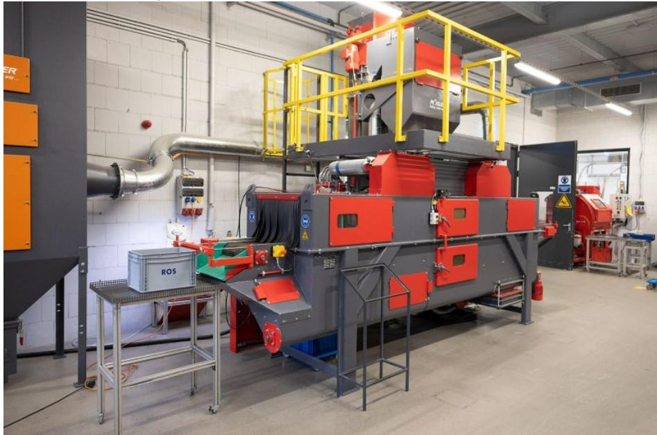
Die Drahtgurt-Durchlaufstrahlanlage wird für das Entgraten von Teilen aus Duroplasten und PPS-GF eingesetzt (Bild: Rösler).
