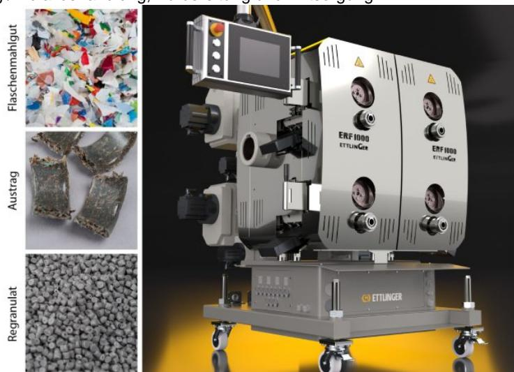
Recycling von PE, PE-HD und PP gehört zu den häufigsten Anwendungen des kontinuierlichen Schmelzefilters (Bild: Ettlinger).
