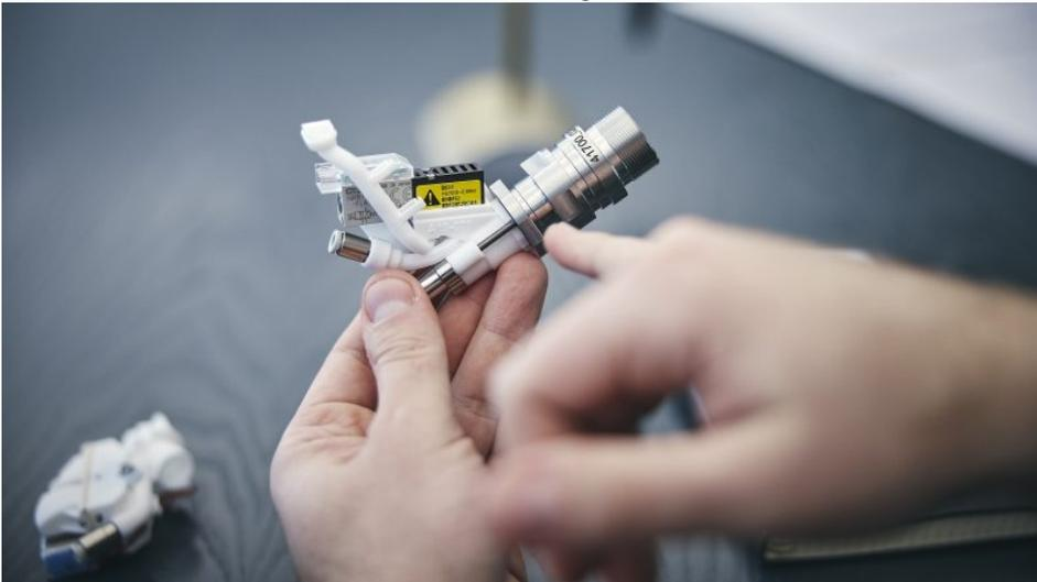
3D-Druck erlaubt ein strömungsoptimiertes Design und die Integration von Funktionen (Bild: Darko Todorovic/1zu1).
