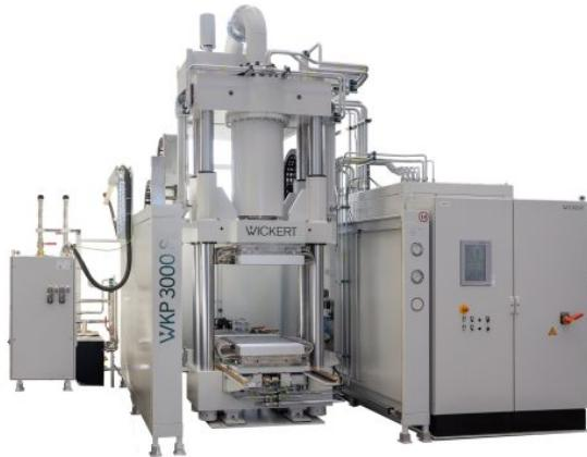
Eine schnelle Heiz-Kühl-Presse mit Temperierraten von mehr als 55 K/min wurde bei der TU Chemnitz installiert (Bild: Wickert).
