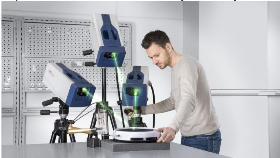
Transportables optisches Messsystem für Auftragsmessungen beim Anwender (Bild: Polytec).
