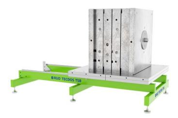
Verschiebbare Aufsetzplatten erlauben ein händisch geführtes und kontrolliertes Öffnen der Werkzeuge und Formen (Bild: RUD).
