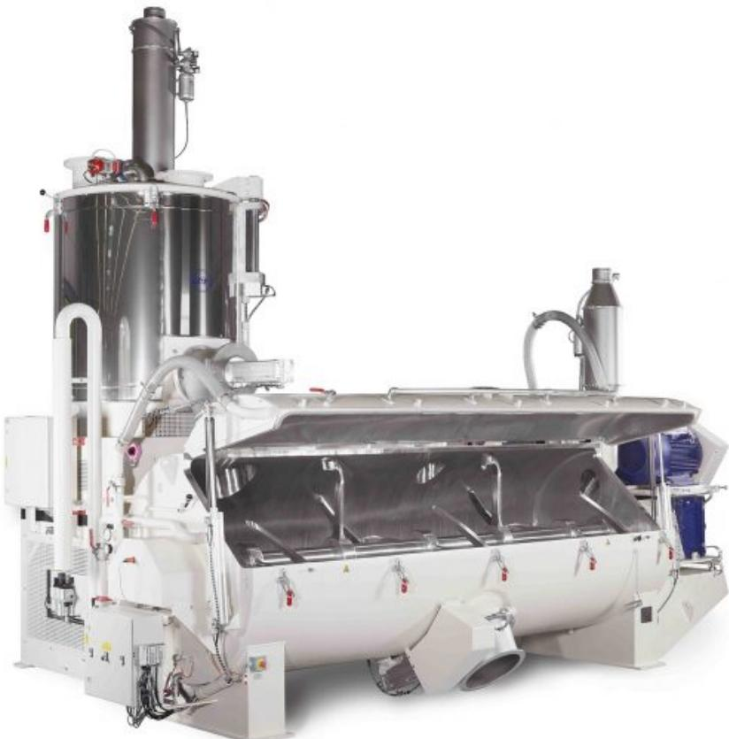
MTI Mischtechnik präsentierte kürzlich eine Heiz-/Kühlmischer-Kombination vom Typ »MTI Flex-line« in der Baugröße »M 2000/K 8000«, die mit 8000 l Kühlbehältervolumen, über sieben Metern Länge und fast fünf Metern Höhe beeindruckende Abmessungen aufweist. Das System wird zukünftig – als größte des vom Hersteller je in die USA gelieferte Heiz-/Kühlmischer-Kombination – die aktuelle Mischkapazität nahezu verdoppeln. Diese Systeme können das erforderliche Mischgut in den entsprechenden
