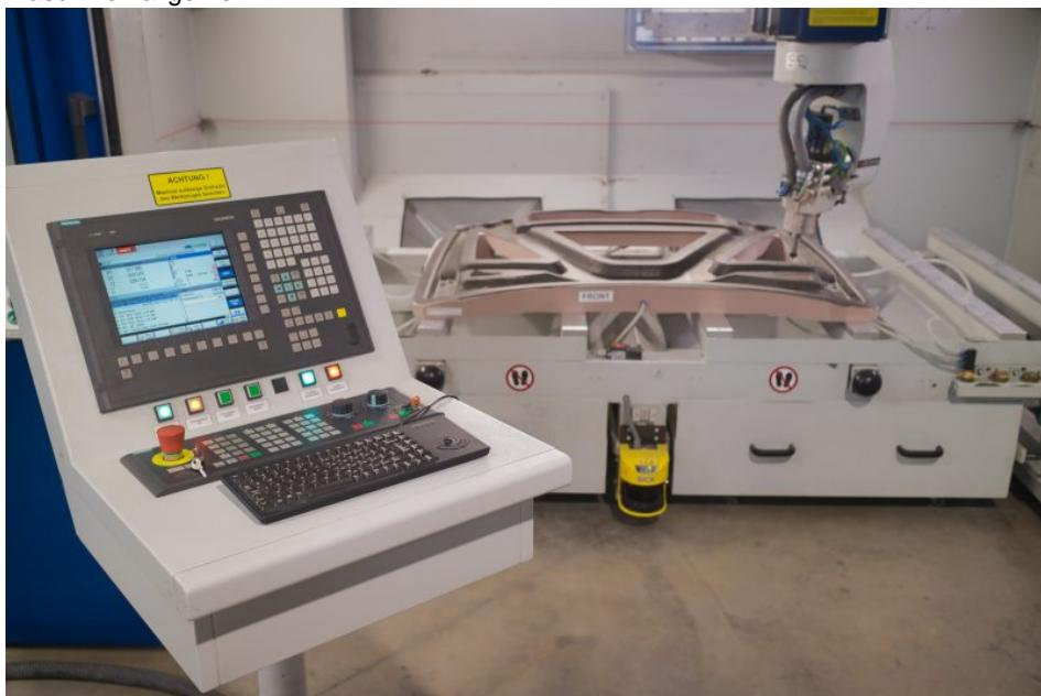
Mithilfe der 5-Achs-CNC-Gantry-Fräsmaschine konnte die Bearbeitungszeit substanziell verkürzt werden (Bild: HG Grimme SysTech.).
