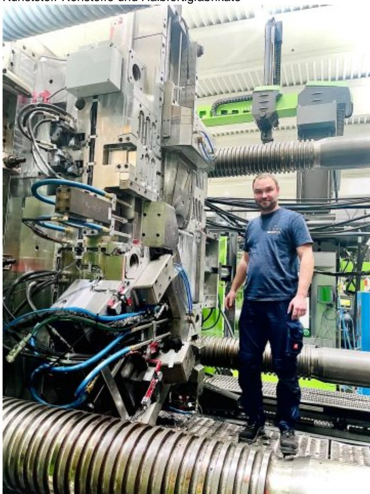
Spritzgießwerkzeug von V Frames für Fahrradkomponenten aus faserverstärkten Verbundwerkstoffen (Bild: Lehvoss).
