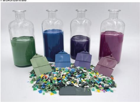
PCR-Schnitzel aus HDPE, die mit verschiedenen Flüssigfarben direkt verspritzt wurden; vorne die Originalfarbe (Bild: Rowasol).
