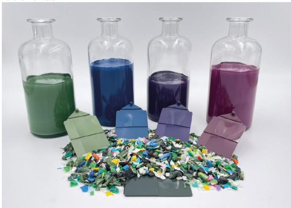
PCR-Schnitzel aus HDPE, die mit verschiedenen Flüssigfarben direkt verspritzt wurden; vorne die Originalfarbe (Bild: Rowasol).
