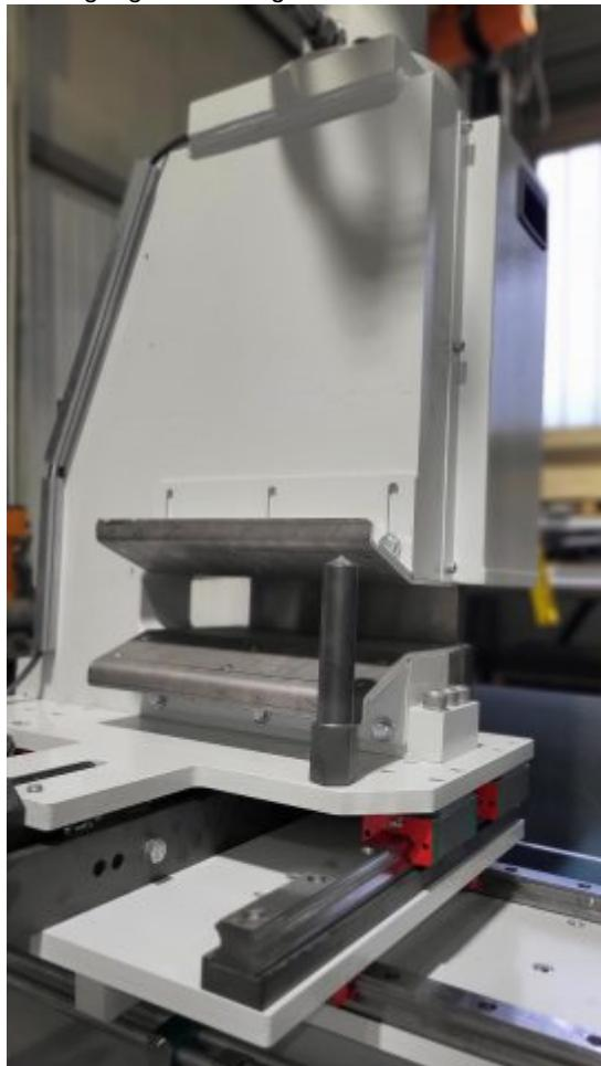
Hydraulik-Guillotine für die Vorzerkleinerung sehr fester, formstabilier und zäher Randbeschnitte aus der Extrusion (Bild: Getecha).
