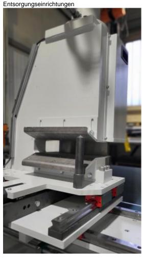
Hydraulik-Guillotine für die Vorzerkleinerung sehr fester, formstabiler und zäher Randbeschnitte aus der Extrusion (Bild: Getecha).
