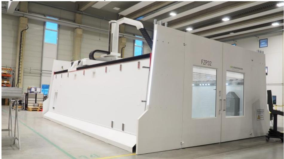
Die 5-Achs-Portalfräsmaschine ist dank ihres thermosymmetrischen Aufbaus sehr genau (Bild: F. Zimmermann).
