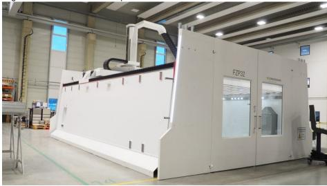
Die 5-Achs-Portalfräsmaschine ist dank ihres thermosymmetrischen Aufbaus sehr genau (Bild: F. Zimmermann).
