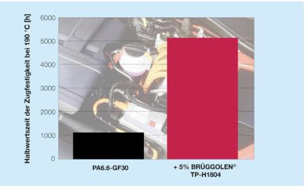
Effektive Stabilisierung von aliphatischen Polyamiden bei erhöhten Dauergebrauchstemperaturen (Bild: Brüggemann).
