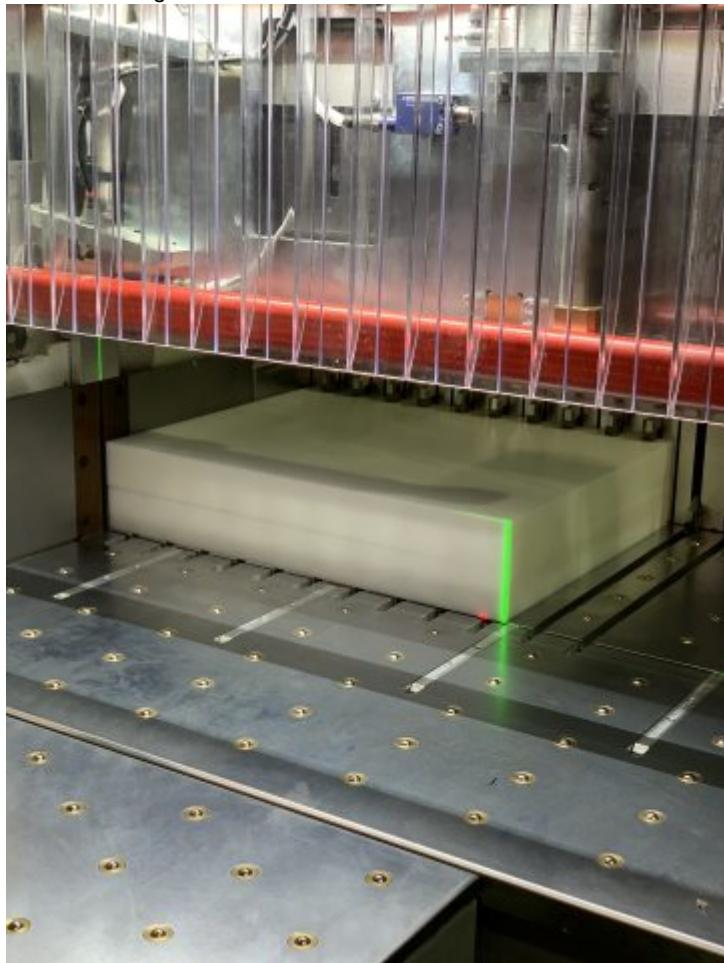
Mit der überarbeiteten Kunststoffsäge ist die Bearbeitung von Paketen oder Platten von bis zu 150 mm möglich (Bild: IMA Schelling).
