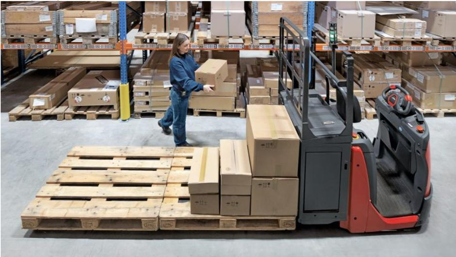
Der halbautomatische Kommissionierer erspart viele Wegstrecken (Bild: Linde Material Handling).
