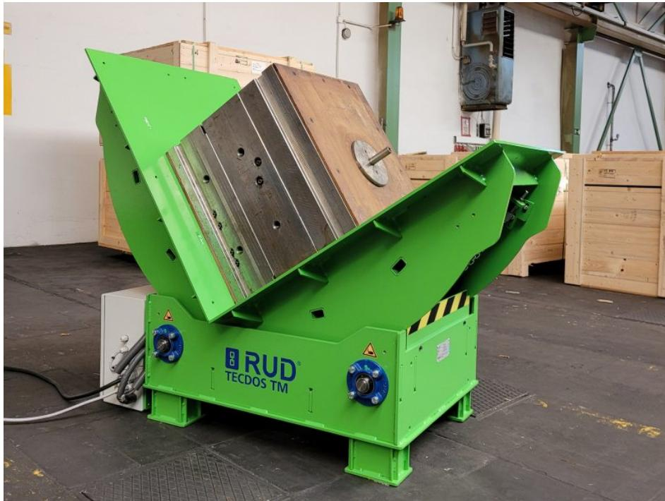
Wenden in 30 Sekunden: Das Werkzeughandling mit der 5-t-Variante geht besonders schnell (Bild: RUD).
