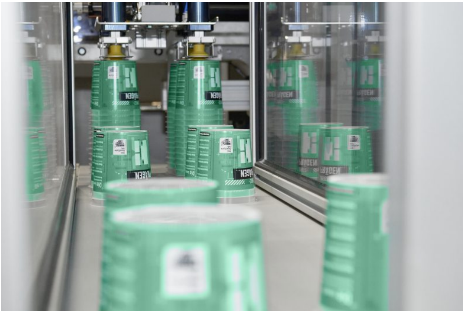
Materialreduzierte Becher, produziert im Spritzprägeverfahren (Bild: Arburg).
