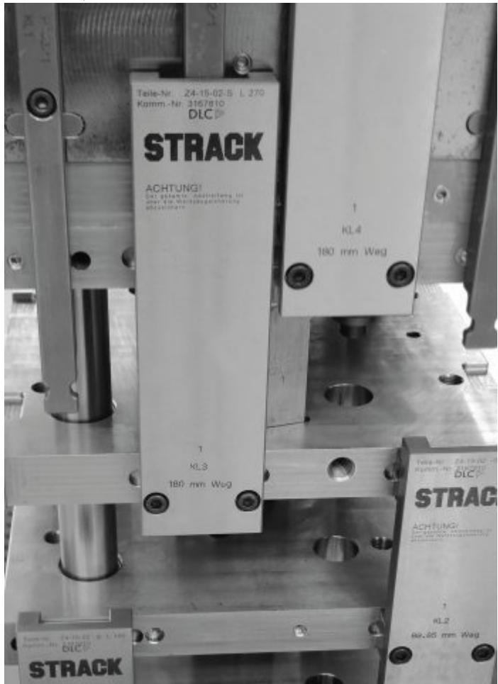
Klinkenzüge, hier im Werkzeug kombiniert, bieten Vorteile gegenüber anderen Konstruktionen (Bild: Strack Norma).
